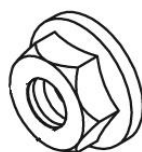
SEMS nakrętka sześciokątna DIN 6923
